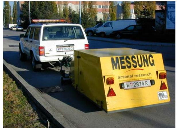
Abbildung 1: Rollgeräuschanhänger nach RVS 11.066 IV und Zugfahrzeug
